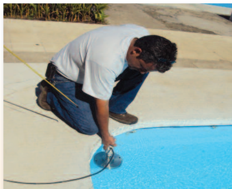
Tilt sensor.(sensor de inclinacion AGI MD900TW).
