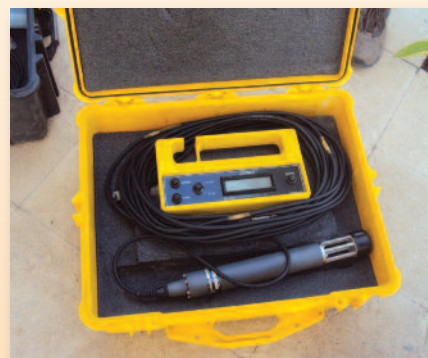
Digi Bar Pro Sound velocimeter: Instrumento utilizado para medir la profundidad por medio de la velocidad del sonido
