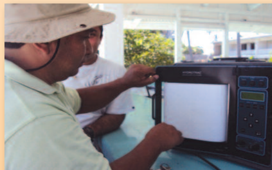
Digi Bar Pro Sound velocimeter: Instrumento utilizado para medir la profundidad por medio de la velocidad del sonido
