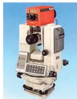
Teodolitos electrónicos con distanciómetros acoplados.
