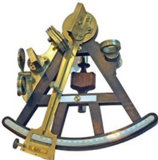
Sextante, en el limbo hacia la izquierda se aprecia el nonio.
