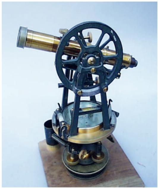
Fig. 4 A la izquierda el tránsito Buff & Buff, del orden de minutos. A la derecha el teodolito Zeiss-Jena, de medio minuto. Instrumentos semejantes a estos fueron utilizados en los trabajos geodésicos por la Comisión Fronteriza y se convirtieron posteriormente en el primer patrimonio técnico del Instituto Geográfico Nacional y el Catastro Nacional (Chaverri, 1994)
