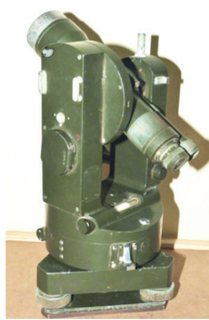
Fig. 4 A la izquierda el tránsito Buff & Buff, del orden de minutos. A la derecha el teodolito Zeiss-Jena, de medio minuto. Instrumentos semejantes a estos fueron utilizados en los trabajos geodésicos por la Comisión Fronteriza y se convirtieron posteriormente en el primer patrimonio técnico del Instituto Geográfico Nacional y el Catastro Nacional (Chaverri, 1994)
